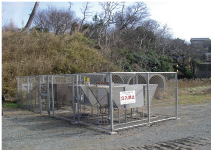
図-2 大気暴露試験装置（海浜地区）
