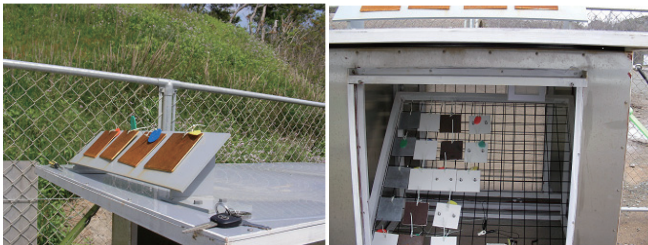
図 - 4 試験片設置状況（左：開放暴露試験片、右：遮へい暴露試験片）
