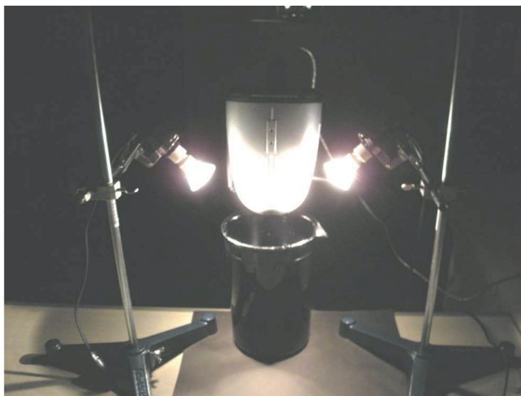
図2 実験室内での分光反射率計測の様子。中央が分光放射計(FieldSpec Handheld)である。
