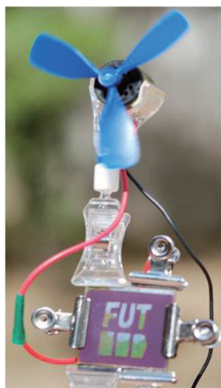
Fig.4 FTO-coated glass/ TiO_2 paste/ N_3 dye.
