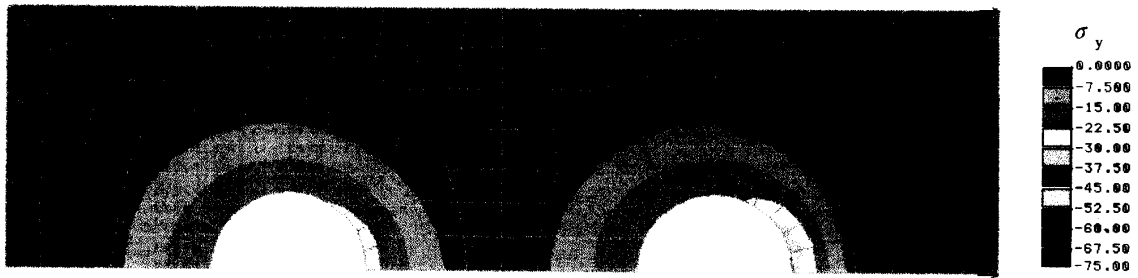
(a) \sigma_y , MODEL-E ( t_s=12\text{mm} , T=8100\text{ kg} )
