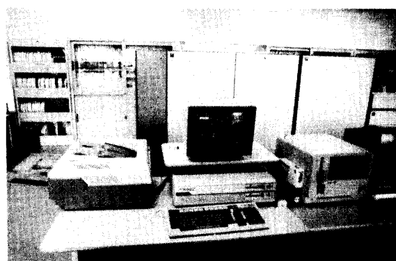
写真9 NECパソコンLANの実験でサーバーとして使用したパソコンPC-98XL 2 （左は共有プリンタとして使用した日本語ページプリンタPC-PR602である。）
