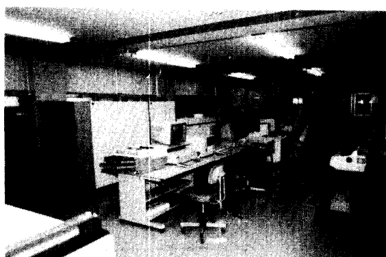
写真8 6号館5階第1ホスト計算機室のNEC汎用中型ホスト計算機ACOS450 システム（CPU＝4MB＋制御用2MB，計算能力＝1.1MIPS，磁気ディスク＝2.54GB）
