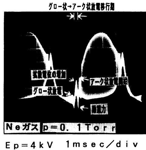
図3. グロー状→アーク状放電移行期にかぎ形複探針に誘起される振動電圧
