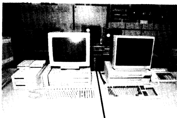
写真1. 教育用学内BBSホスト（通信速度評価実験の時の様子）；左より、モデム（オムロンMD24FB5VとマイクロコアMC14400FX）、富士通ISPT、40MBハードディスク、NECパソコン（PC-9801DA2とPC-9801M）、富士通Digital Phone 100AP。
