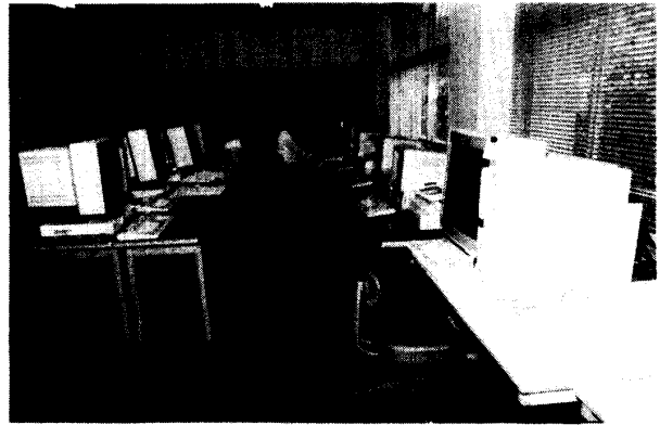
写真8 IBMのUNIXワークステーションPower Station 320 (CPU=POWER, 計算能力=29.5MIPS, 8.5MFLOPS), X Station (カラー, モノクロ), パソコン5540, PC9801RA, Digital-Phone 100AP
