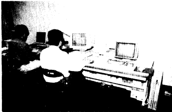
写真9 CAD準備室の(左)UNIXワークステーションSun4/2 (CPU=SPARC, 計算能力=28.5MIPS, 4.2MFLOPS) と I S P T, (右) パソコンPC98XL 2 と Digital-Phone 100AP
