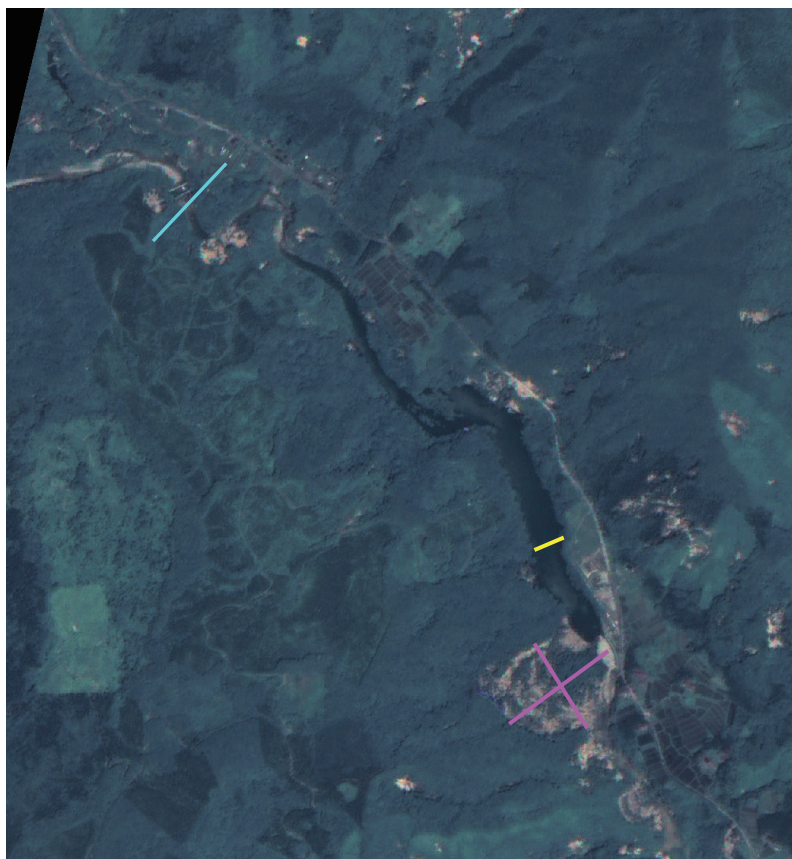
図 5. 岩手県一関市巖美町市野々原の山崩れによる磐井川の河道閉塞状況を示す 2008 年 7 月 2 日のパンシャープン・トルーカラー画像 (縦 2.7km, 横 2.5km, 等価解像度 2.5m)
