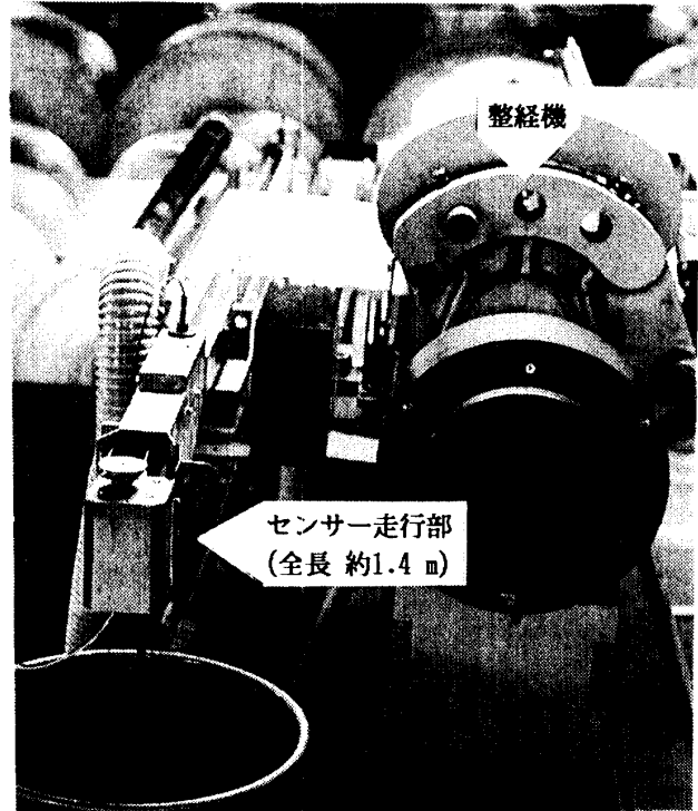
図5 整経機に装着したセンサー走行部
