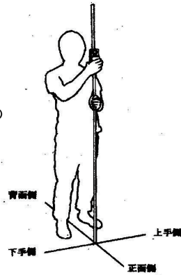
図 3.2 鉛直面照度の測定
