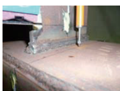
(a) フランジ縁端溶接亀裂
