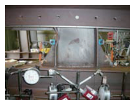
(b) 梁のウェブ、フランジの局部座屈
