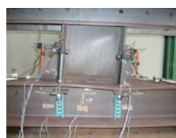
(b) 梁のウェブ、フランジの局部座屈
