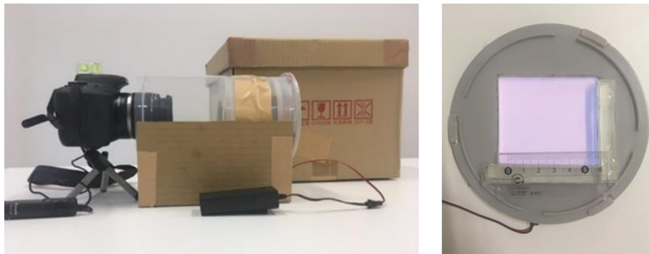
図 6-3 PVA-KI ゲル撮像装置 (左：全体像、右：試料設置箇所)
