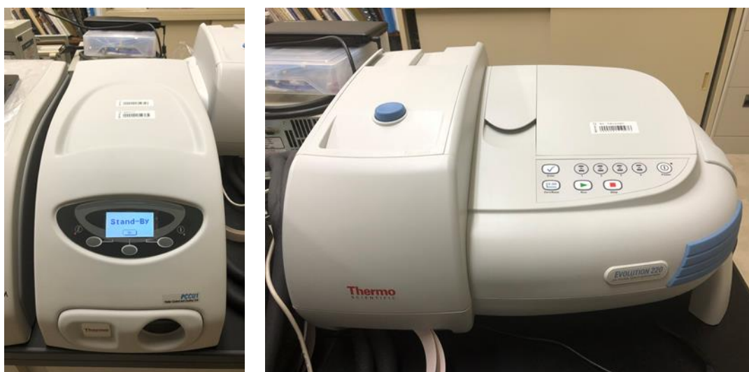
図 4-1 右：紫外可視分光光度計(Thermo Scientific EVOLUTION 200) 左：ペルチェ温調システム(Thermo Scientific TUV699-131100)
