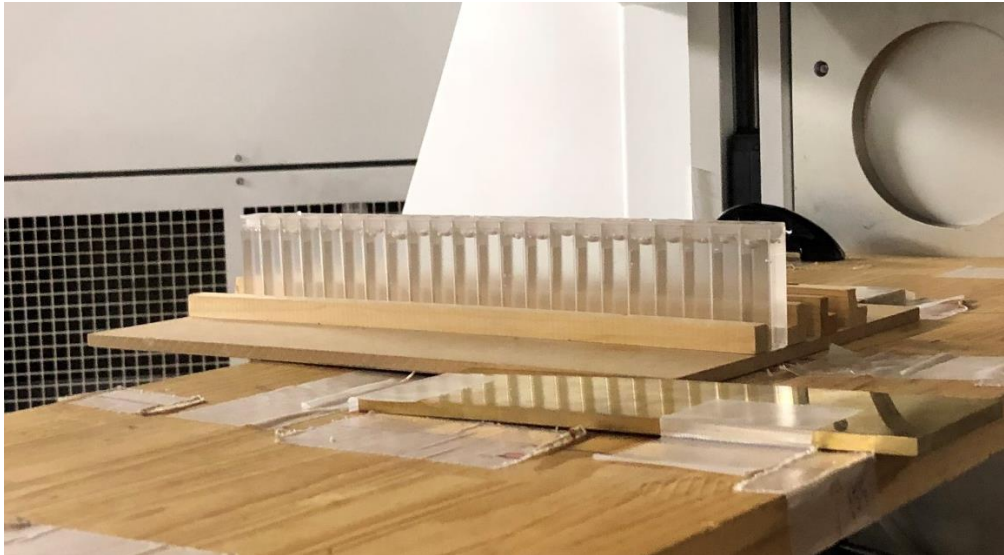
図 5-1 陽子線照射前の試料の設置の様子 (図左方向がビーム上流側)
