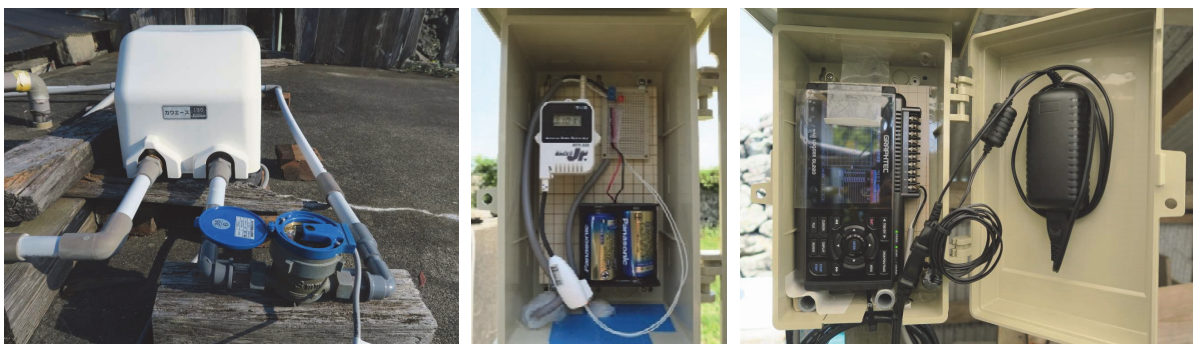
図3 赤島の戸建住宅に設置した水量メータ（左）とデータ記録部（電池（中）、データロガー（右））
