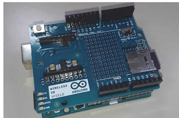
図 2 Arduino UNO と Arduino Wireless SD Shield
