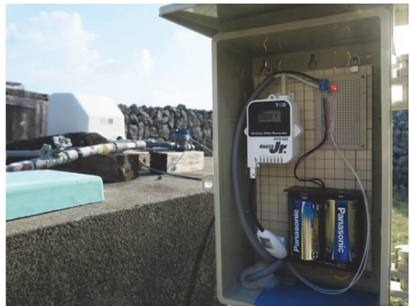
図5 使用水量計測装置電圧測定部とワイヤレスデータロガー子機
