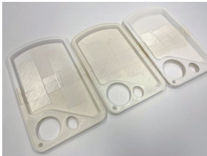
Fig. 9 3Dプリンターを活用したプロトタイプ
