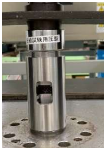
図 15 NAL 治具圧縮試験風景
