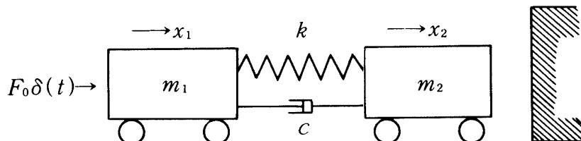
物体  $m_1$  および  $m_2$  がスプリング  $k$  によって連結されこれが一平面上にあり衝撃力  $F_0$  をうける時  $c = 0$  とするとこの運動方程式は次のようになる。
