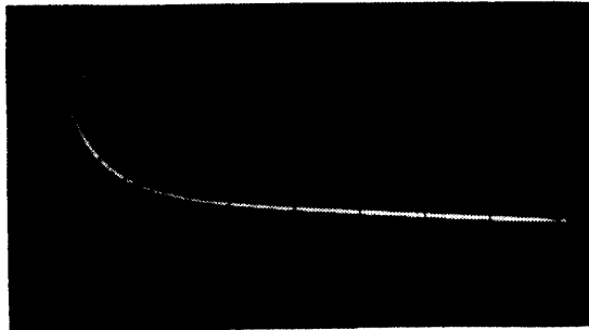
第14図 直流高圧電源による電流波形の拡大図
