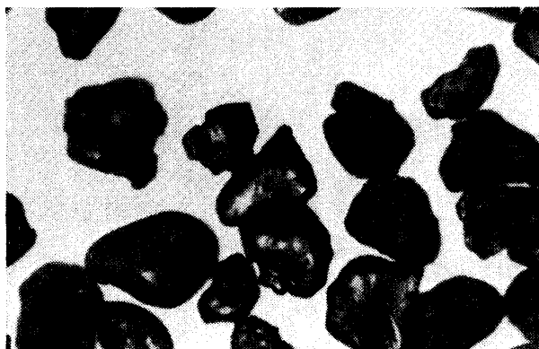
写真4. 3 フリマントルサンド 100 mesh 倍率100 (多角形)
