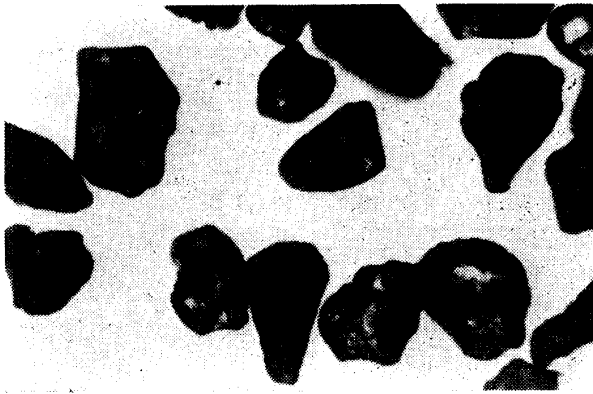
写真4. 5 フラタリーサンド 100 mesh 倍率100 (多角形)
