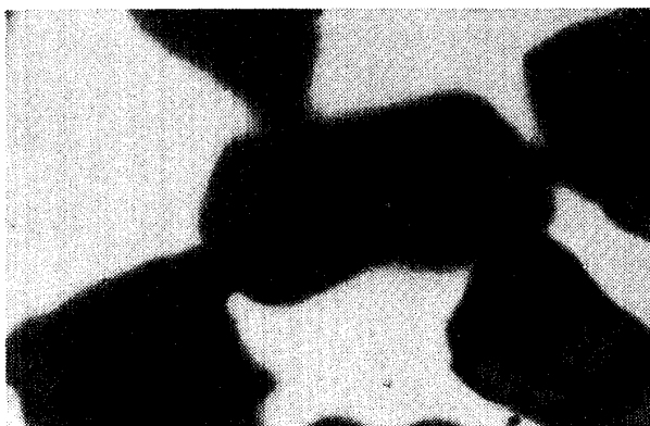
写真4. 1 越前砂48 mesh (多角形) 倍率100
