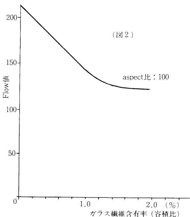
今(図2)は、アスペクト比 100 (aspect ratio =  $\frac{L}{d}$  L・纖維の長さ, d・纖維の径) のガラス纖維がモルタルに混入された場合の含有率に対応するフロー値を示したものである。
