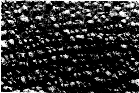
写真-3 試料B-1のCrめっき層の窒素処理後の割れ (×400)
