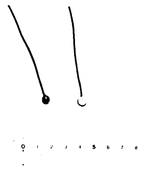
図2 銀・塩化銀電極（眼振用）
