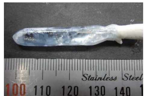
図 3. Si ドープ \beta -Ga 2 O 3 単結晶
