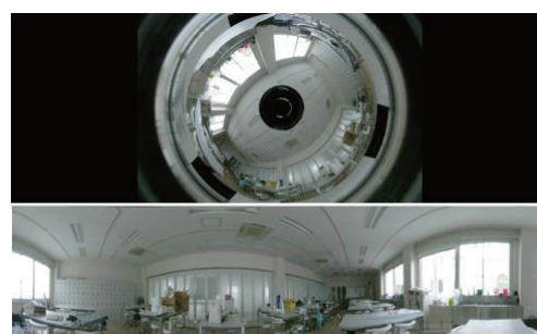
図 3 ワンタイムパノラマミラーによる撮影画像と処理後のパノラマ画像
