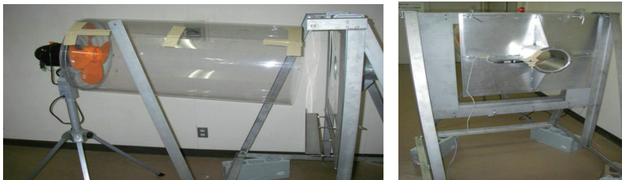
図 2-1 風速測定試験装置（側面及び正面）
