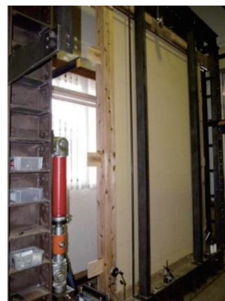
写真 2 変位計の設置状況
