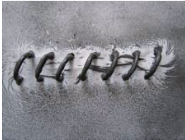
図5 ソレノイドを流れる電流がつくる磁場の様子
