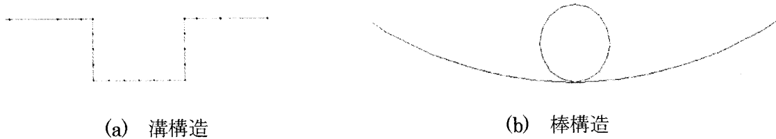
図8 パーティクルトラップの基本構造
