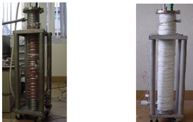
(a) ベルトヒーター巻付け (b) 保温材巻付け
