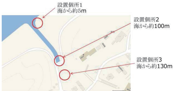
図. 7 アルミニウム試験片の設置箇所
